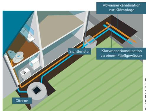
Im Falle eines Trennsystems, das nur aus einem einzigen Rohr besteht, welches nur für ungeklärte Abwässer vorgesehen ist, darf klares Wasser dort nicht abgeleitet werden. (Artikel R. 277 Wassergesetz)
